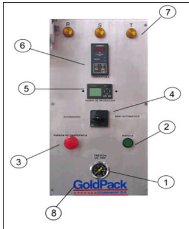
Figura #7, Tablero de Control.
