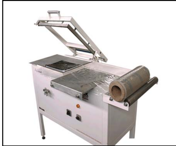
Figura # 5, Vista general de la máquina y colocación del film.
